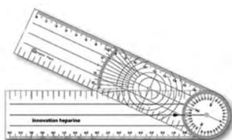
Използва се от хирурзите – ортопеди за измерване на обхвата на движение на ставите: лактите, коленете и пръстите. С кръгла скала, използвана за проверка размера на тазобедрените стави и ъгъла на шийката на бедрената кост при изследване с рентген.
