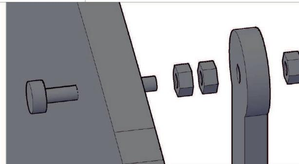
Механизмът за люлеене се монтира, като болт се прокарва през таблата на леглото (скрина), завиват се две гайки, поставя се пластмасовият механизъм и се затяга с трета гайка.
