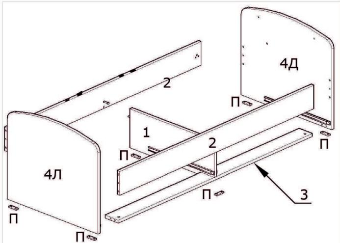
Пластмасовите пети П се захващат чрез видии за детайли 1, 3, 4л и 4д. Детайл 1 се захваща за детайли 2 чрез минификс сглобка и дибли, и към детайл 3 - чрез евровинт. Детайли 2 и 3 се захващат за таблите 4л и 4д чрез дибли и шведска сглобка.
