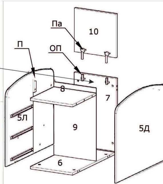
На таблите се монтират водачите за чекмеджетата посредством видии. Табла 5л се поставя на земята. За нея се захващат детайли 6, 7, 8 и 9 чрез минификс сглобки и дибли. Таблата 5д затваря скрина. На гърба 7 се монтират основите на пантите ОП и механизмът за плавно спускане на капака. Капакът 10 се фиксира към скрина чрез пантите Па.
