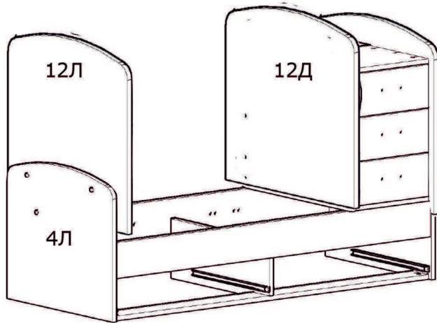
Таблите на коша са лява и дясна. Повечето отвори остват от вътрешния край на коша. Таблата 12л се захваща за механизмите на табла 4Л. Табла 12Д се захваща за механизмите на табла 5Л. **Внимание! Придържайте таблите във вертикално положение, защото ще се счупят механизмите!**
