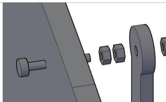
Механизъмът за люлеене се монтира, като болт се прокарва през таблата на леглото (скрина), завиват се две гайки, поставя се пластмасовият механизъм и се затяга с трета гайка.
