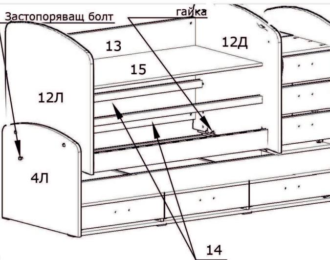
Гърбът 13 се захваща за таблите 12Л и 12Д с шведска сглобка и дили. Шперплат дъските 14, чрез които се регулира нивото на дъното на коша, се захващат за таблите 12Л и 12Д чрез евровинтове. Върху дъските 14 се поставя дъното на коша 15 (гола ПДЧ с дебелина 16мм).
