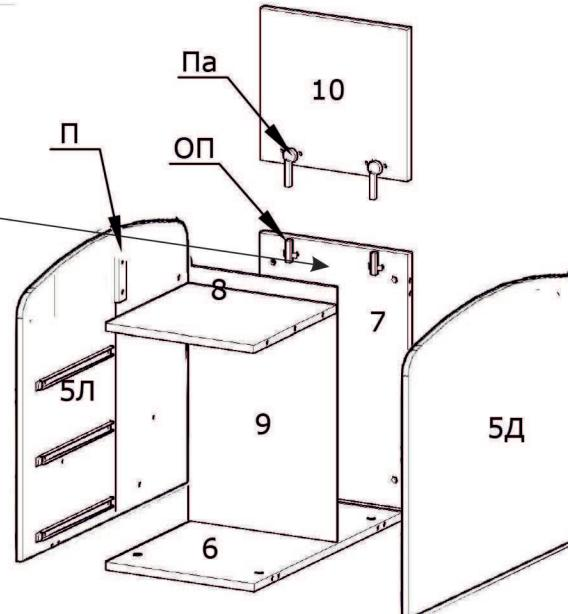
На таблите се монтират водачите за чекмеджетата посредством видии. Табла 5л се поставя на земята. За нея се захващат детайли 6, 7, 8 и 9 чрез минификс сглобки и дубли. Таблата 5д затваря скрина. На гърба 7 се монтират основите на пантите ОП и механизъмът за плавно спускане на капака. Капакът 10 се фиксира към скрина чрез пантите Па.
